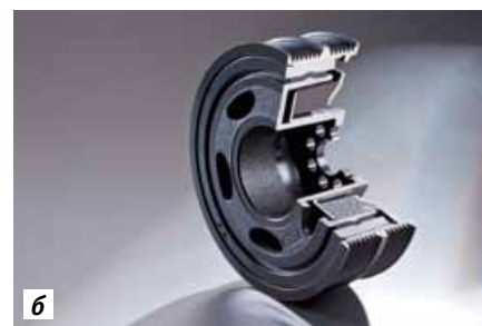
Фото 2. Гаситель крутильных колебаний в сборе (а) и входящий в его состав ременный шкив в разрезе (б) (фото: Provido)
