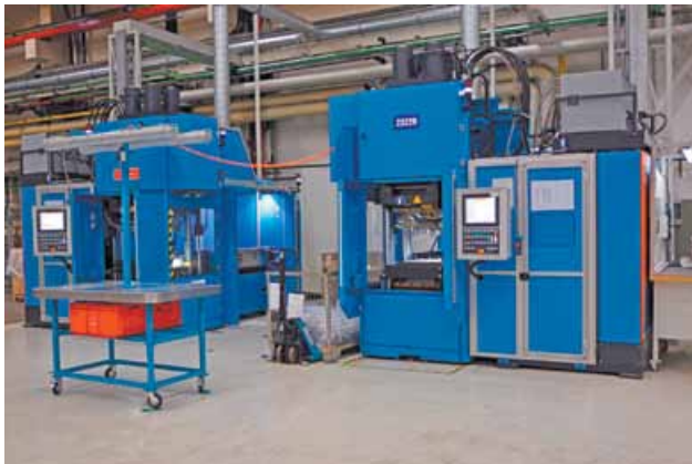
Фото 5. Вертикальные литьевые машины модели MTF 2600/280 с синхронными двойными челночными системами Fast Double Shuttle (фото: Provido)
