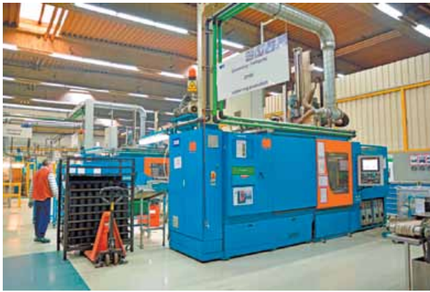
Фото 3. Горизонтальные литьевые машины модели MHF 2600/460 для производства резиновых колец из ЭПДМ (фото: Provido)
