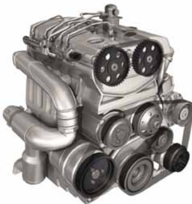
Фото 1. Моторный блок автомобиля Jaguar с ременной передачей, в состав которой входит гаситель крутильных колебаний (фото: Winkelmann)
