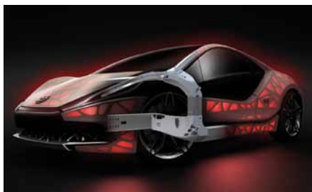
Technologiebeispiel NextGen Spaceframe: Funktionsintegrierte, bionisch optimierte Fahrzeugleichtbaustruktur in flexibler Fertigung zeigt mit dem bionisch optimierten, generativ-hybrid gefertigten Spaceframe-Konzept eine neue Perspektive auf, wie ein wandelbares und extrem flexibles Produktionskonzept für laststufengerecht ausgelegte Karosserien realisiert werden könnte
